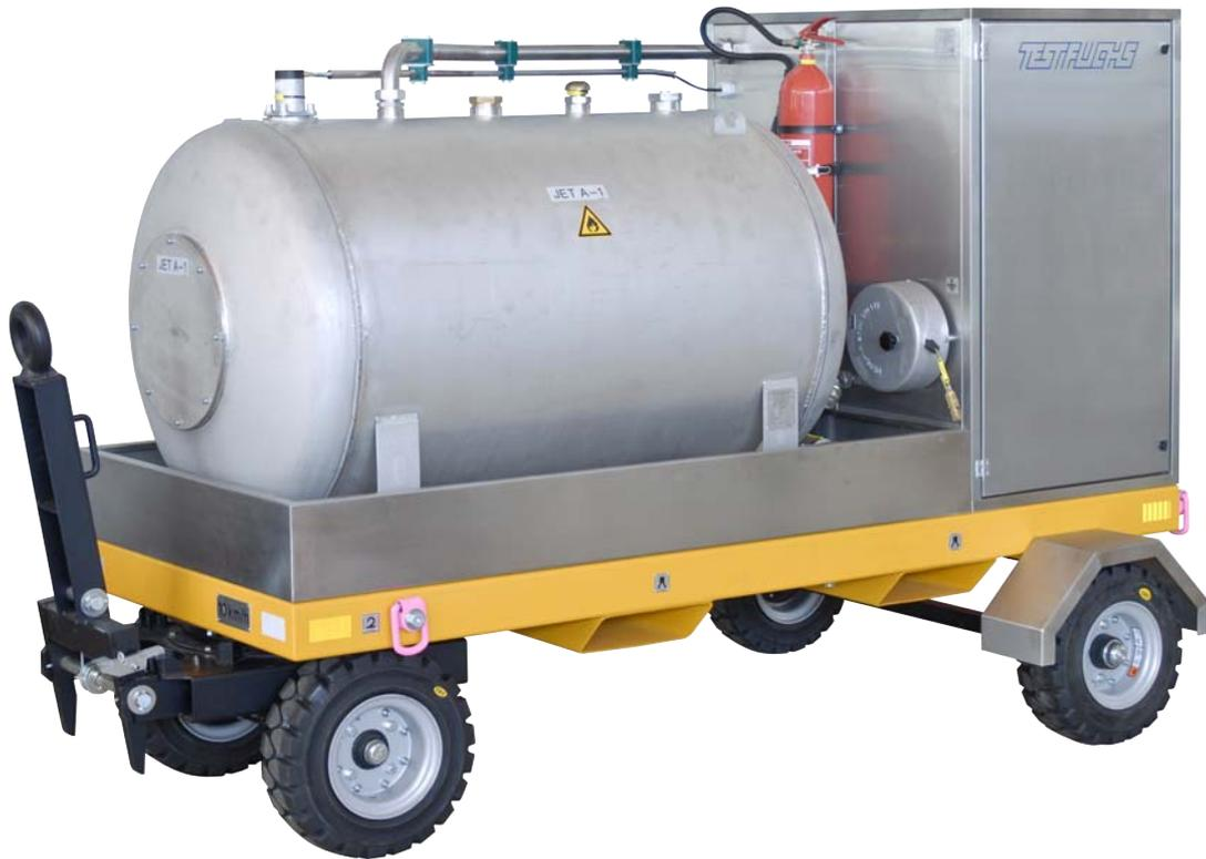
Entwickelt zum Absumpfen von Kraftstoffkreisläufen und -tanks aller gängiger Luftfahrzeugtypen.
