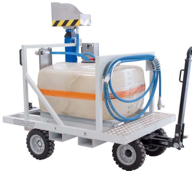
Water Collection Trolley zum Auffangen des Wassers am Drainmast (500l)
