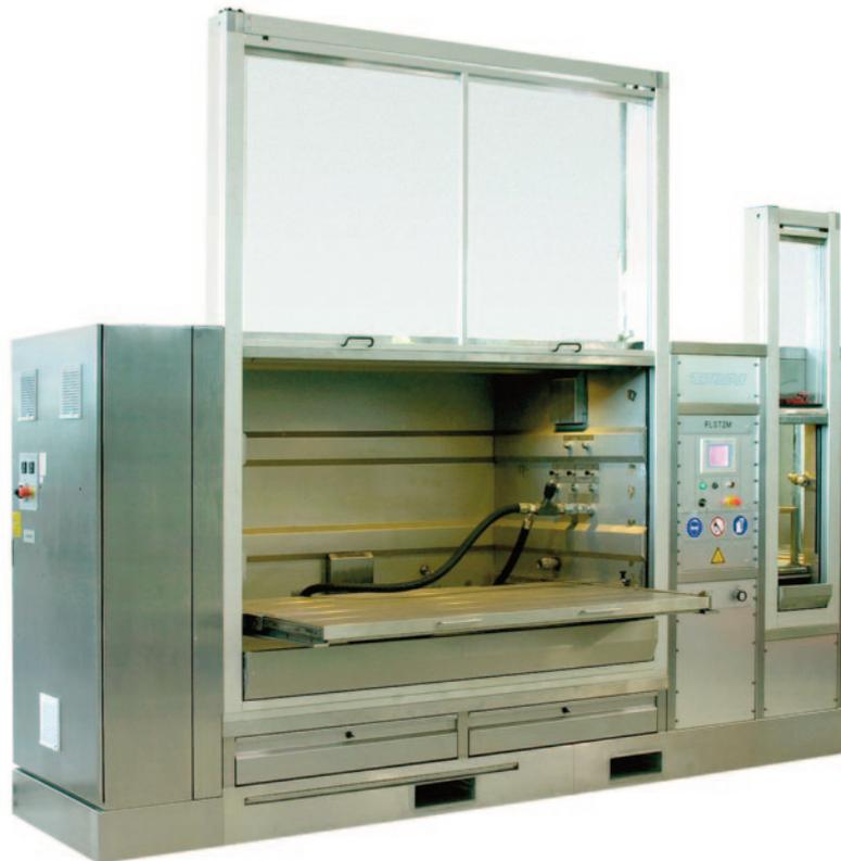
Zum Prüfen von Oil Nozzlen, Lagerdämpfung der Triebwerkslager usw.
