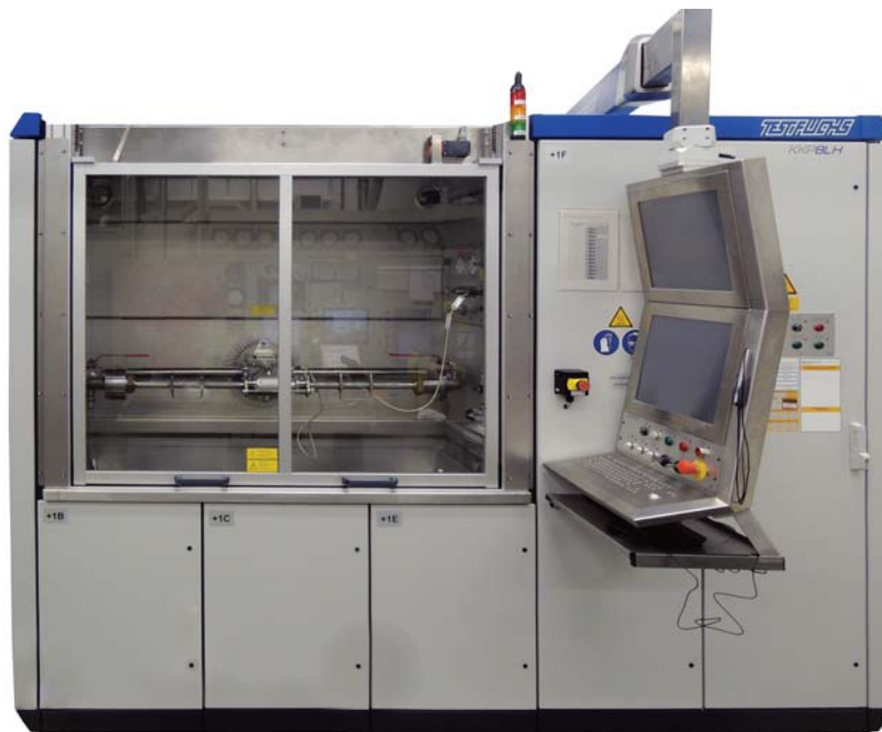
Prüfstand mit Elektronikschaltschrank und Bedieneinheit
