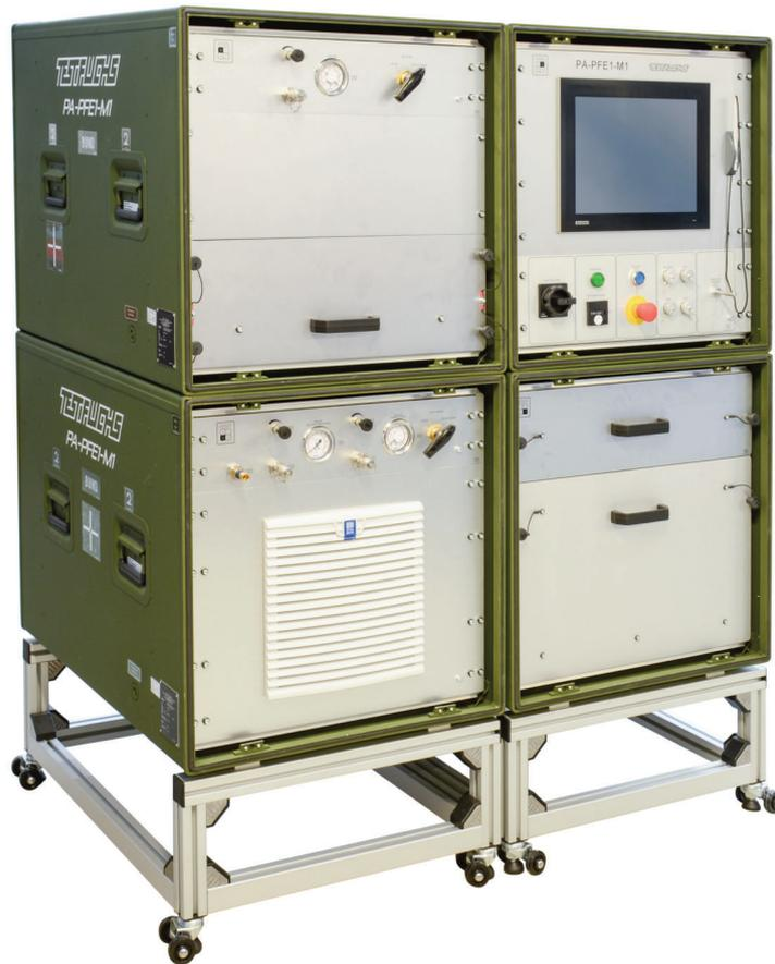
Entwickelt für das Prüfen von Schwimmwesten und Rettungsschlauchbooten auf Dichtheit und Druckfestigkeit.
