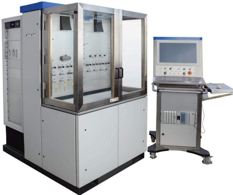
Die Anlage dient zum Prüfen von Pilotventilen mit dem Medium MIL H-5606H und MIL-83282.
