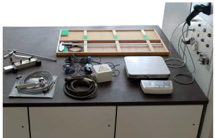
zusätzliche Messmittel (Waage, Schiebelehre, Neigungssensoren, , Barcodescanner)
