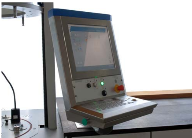
flexibel verstellbares Bedienpanel mit Schwenkarm
