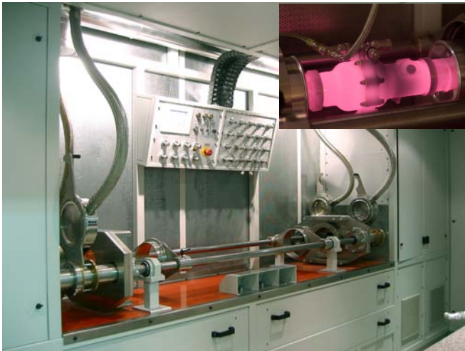
Arbeitsbereich für dynamische Tests mit Schnellspannvorrichtung
