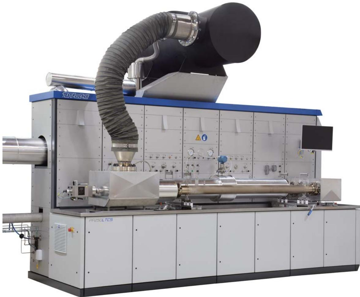
Entwickelt zur universellen Überprüfung von High-Flow Components (z.B. Ventile) laut ATA Chapter 36 auf deren Parameter wie Druck, Temperatur, Durchfluss und Leckage.
