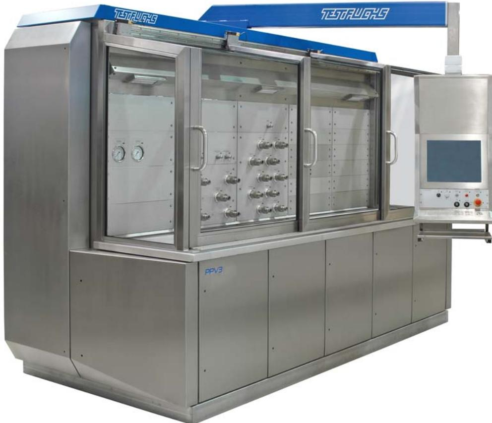
Entwickelt zum Prüfen von verschiedenen pneumatischen Triebwerkskomponenten auf deren einwandfreie Funktion.
