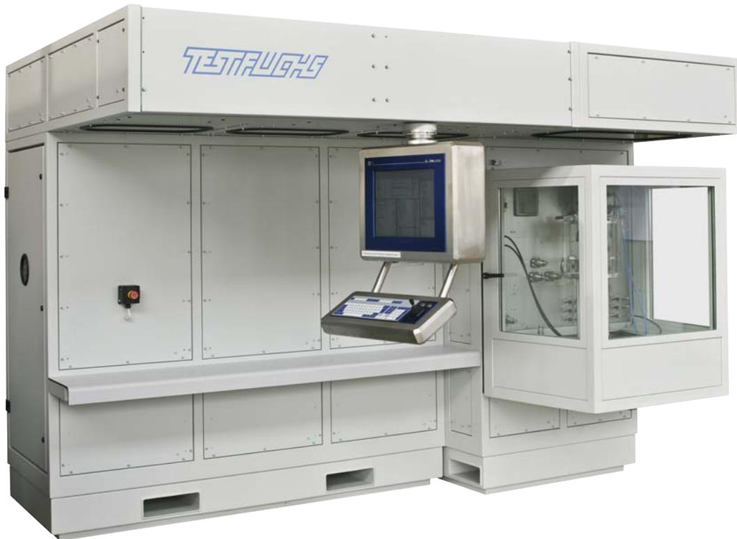
Entwickelt für die Prüfung von APU-Kraftstoffpumpen, -Reglern und -Einspritzdüsen der Waffensysteme TORNADO und EUROFIGHTER.
