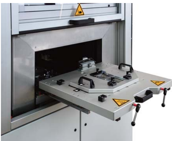
Montageplatte mit Schnellspannsystem am Hubtisch
