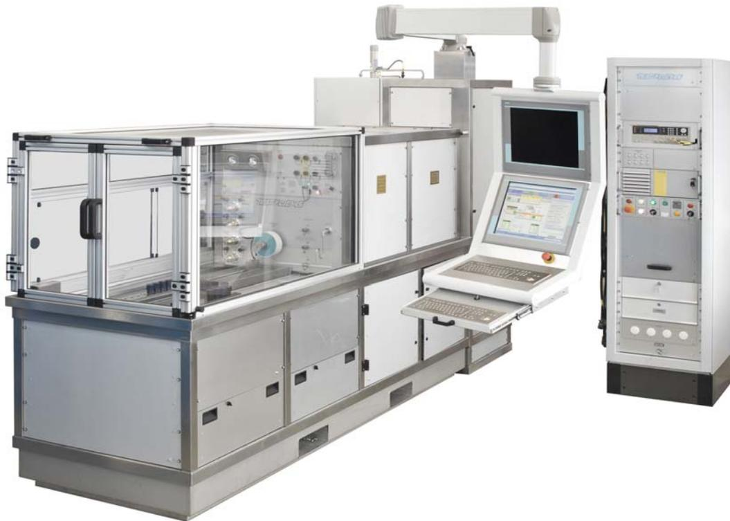
Entwickelt für die Prüfung von Flight Control Units - zum Beispiel von BOEING 777.
