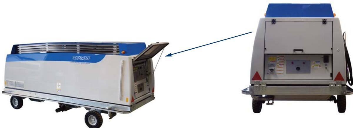
Die Wetterschutzabdeckung kann mit Riegelverschlüssen leicht geschlossen werden
