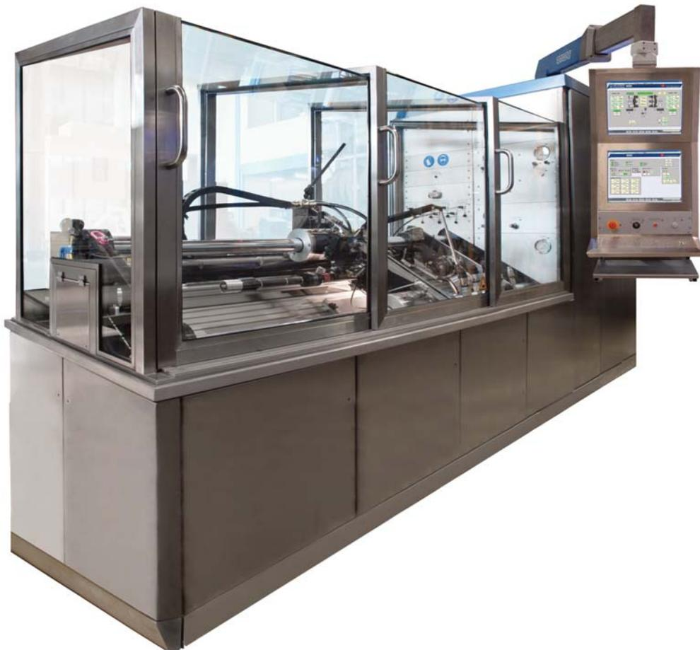
Entwickelt zur Funktionsprüfung von Flugkontroll-Komponenten für 3000 und 5000psi Systeme.
