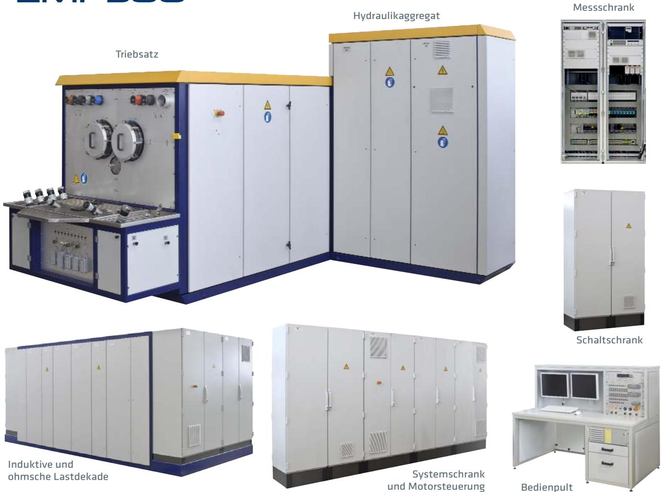
Entwickelt für die Prüfung von luft- und ölgekühlten AC und DC-Generatoren, VSCFs, CSDs, IDGs und DC-Starter und DC-Startergeneratoren aller gängiger Hersteller.
